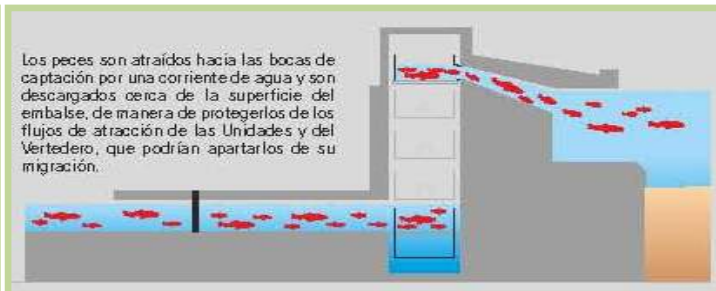
Gráfico N° 4: Corte del Sistema de Transferencia
