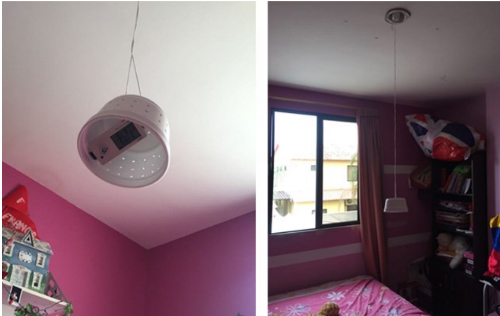
Figura 63. Ubicación de micro-adquisidor de datos en dormitorio 1
