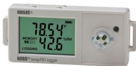
Figura 57. HOBO modelo UX100-011
