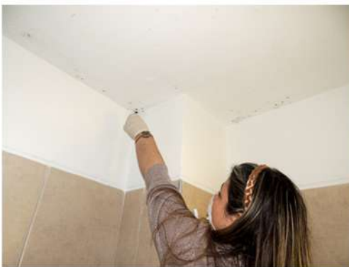
Fig. 29_Toma de muestra con hisopo estéril en baño (M1) Fuente: imagen propia de la autora
