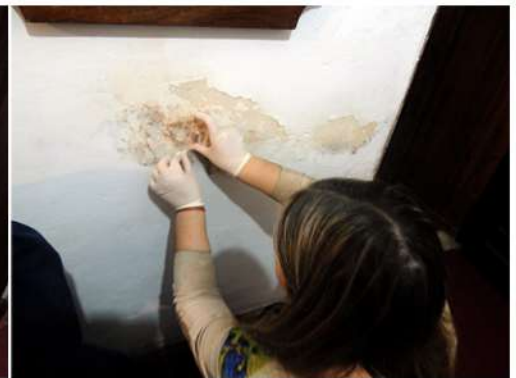
Fig. 34_Toma de muestra con cinta en pared interior de dormitorio ppal. Fuente: imagen propia
