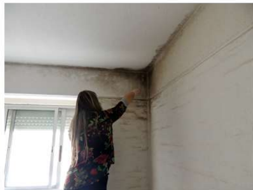
Fig. 34_Toma de muestra con hisopo estéril en el dormit. sec. (M1) Fuente: imagen propia de la autora
