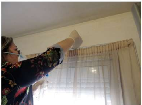
Fig. 27_Toma de muestra con hisopo estéril en dintel del estar-comedor (M1) Fuente: imagen propia de la autora
