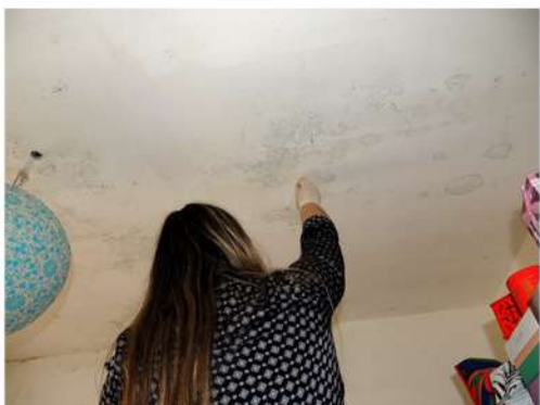
Fig. 33_Det. de toma de muestra con cinta en estar-comedor (M2) Fuente: imagen propia de la autora
