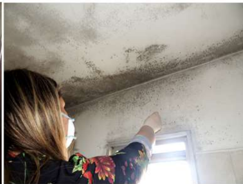
Fig. 31_Toma de muestra con hisopo estéril en cielorraso del baño (M2) Fuente: imagen propia de la autora
