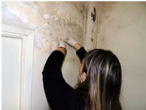
Fig. 33_Toma de muestra con cinta en sala de reuniones (M9) Fuente: imagen propia de la autora
