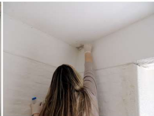
Fig. 30 Toma de muestra c/hisopo estéril en cielorraso del dormit. ppal. (M1) Fuente: imagen propia de la autora
