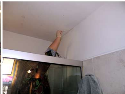
Fig. 25_Toma de muestra con hisopo estéril en cielorraso del baño (M2) Fuente: imagen propia de la autora
