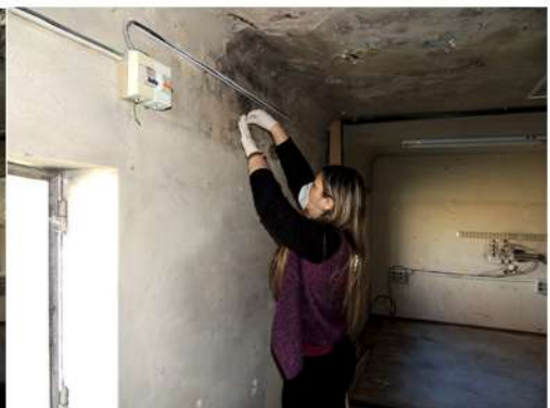
Fig. 38_Toma de muestra con cinta en oficina clausurada de PA (M4) Fuente: imagen propia de la autora
