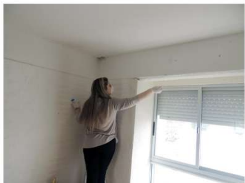
Fig. 32 Toma de muestra c/hisopo estéril en cielorraso del dormit. ppal. (M1) Fuente: imagen propia de la autora
