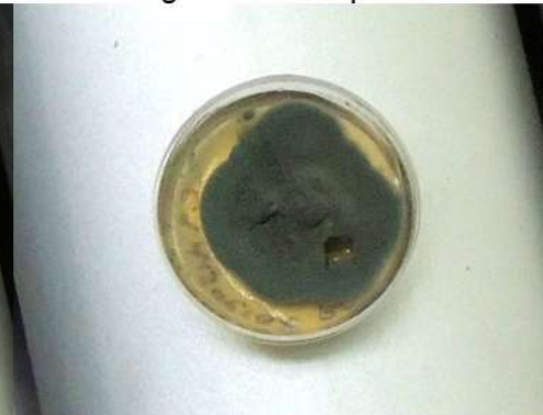
Fig. 43_ Penicillium crustosum encontrado en cielorraso PB (M5) Fuente: fotografía tomada por la autora
