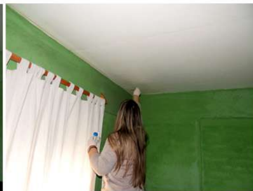
Fig. 29_Toma de muestra con hisopo en el dormit. ppal. (M1) Fuente: imagen propia de la autora
