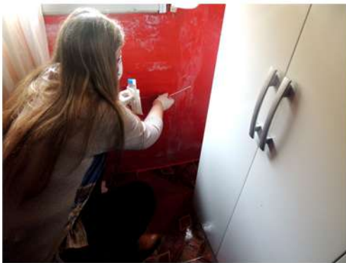
Fig. 25_Toma de muestra con hisopo estéril en dormitorio secundario (M2) Fuente: imagen propia de la autora
