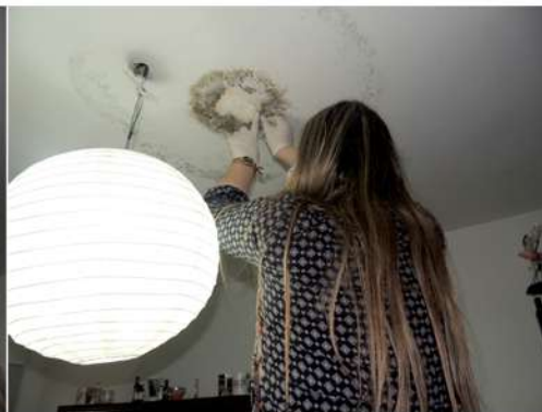
Fig. 31_Toma de muestra con cinta en cielorraso de estar-comedor (M1) Fuente: imagen propia de la autora
