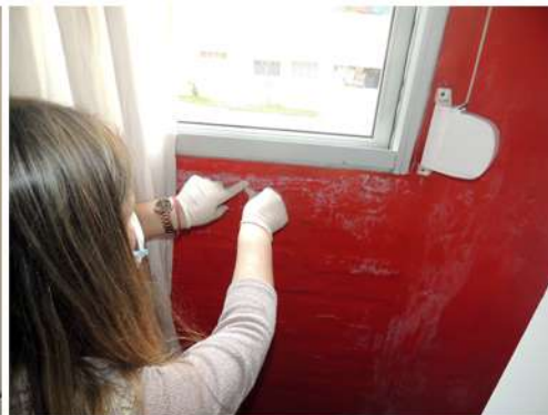
Fig. 26_Toma de muestra con cinta en antepecho del dormit. sec. (M2) Fuente: imagen propia de la autora
