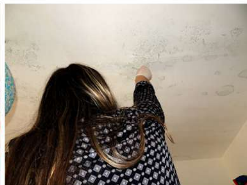
Fig. 34_Toma de muestra con hisopo estéril en cielorraso de estar-comedor (M3) Fuente: imagen propia de la autora
