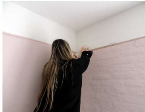
Fig. 26_Toma de muestra con cinta en pared del dormit. ppal. (M1) Fuente: imagen propia de la autora
