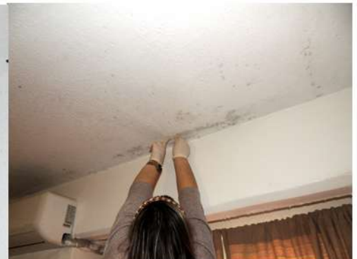
Fig. 31_Toma de muestra con cinta en dormit. ppal. (M2) Fuente: imagen propia de la autora
