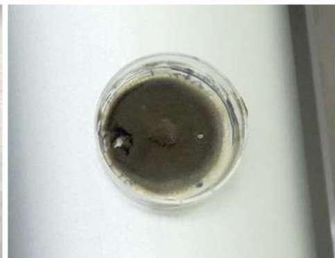
Fig. 32_ Cladosporium sp. encontrado en el cielorraso del estar-comedor (M1) Fuente: fotografía tomada por la autora
