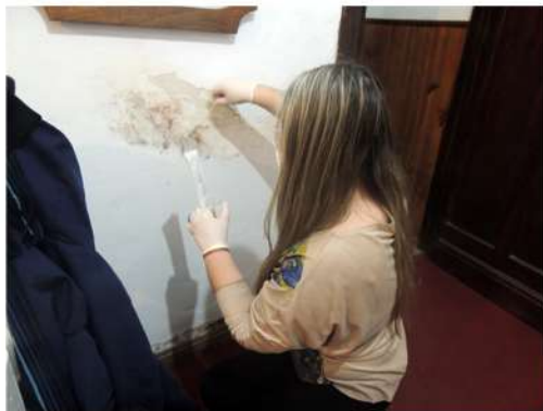
Fig. 32_Toma de muestra con hisopo estéril en pared interior de dormitorio ppal. Fuente: imagen propia
