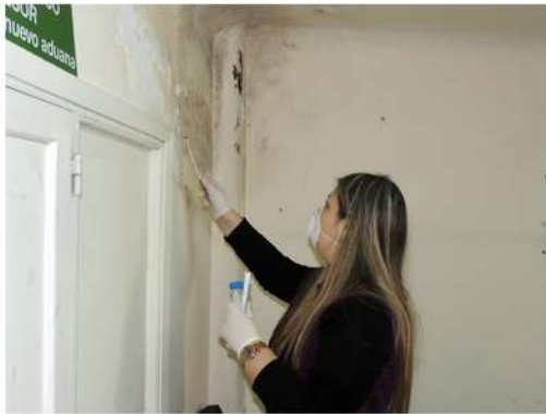
Fig. 39_Toma de muestra con hisopo estéril en sala de reuniones (M9) Fuente: imagen propia de la autora
