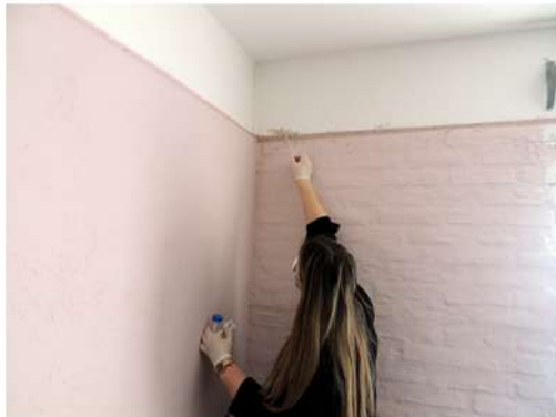
Fig. 25_Toma de muestra con hisopo estéril en pared del dormit. ppal. (M1) Fuente: imagen propia de la autora
