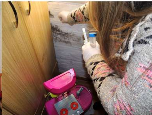
Fig. 30 Toma de muestra con hisopo estéril en antepecho de dormit. sec. (M1) Fuente: imagen propia de la autora
