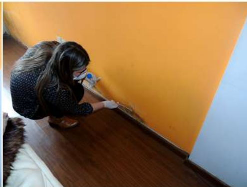
Fig. 30 Toma de muestra con hisopo estéril en zócalo de estar-comedor (M2) Fuente: imagen propia de la autora
