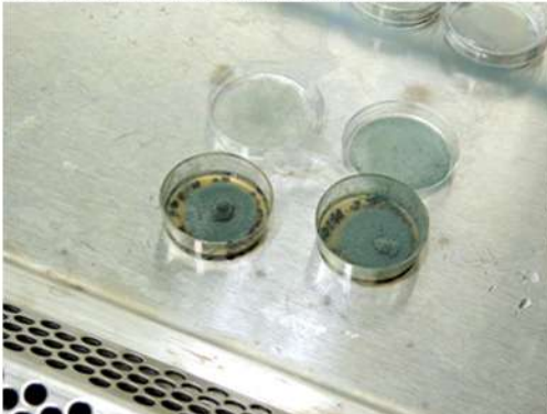
Fig. 44_Placas de PDA con el cultivo de las muestras extraídas de la vivienda Fuente: fotografía tomada por la autora
