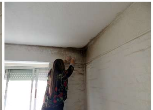
Fig. 35_Toma de muestra con cinta en el dormit. sec. (M1) Fuente: imagen propia de la autora
