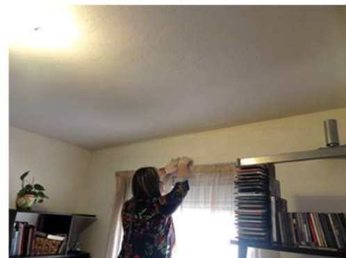
Fig. 28_Toma de muestra con cinta en dintel del estar-comedor (M1) Fuente: imagen propia de la autora
