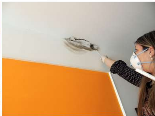
Fig. 33 Toma de muestra con hisopo estéril en cielorraso de estar-comedor (M3) Fuente: imagen propia de la autora
