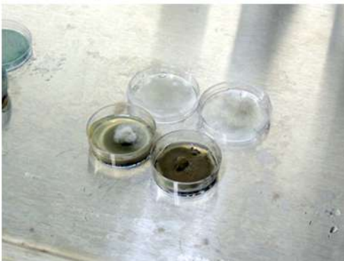
Fig. 47_Placas de PDA con el cultivo de las muestras extraídas de la vivienda Fuente: fotografía tomada por la autora
