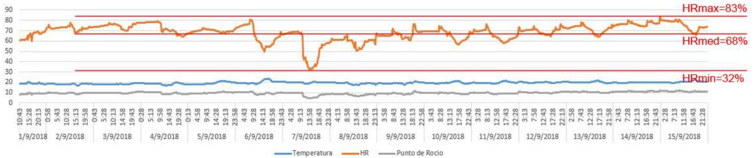
Gr. 1_ Condiciones ambientales interiores: temperatura, HR y punto de rocío del caso de estudio
