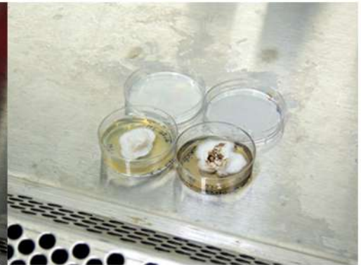
Fig. 40_Placas de PDA con el cultivo de las muestras extraídas de la vivienda Fuente: fotografía tomada por la autora
