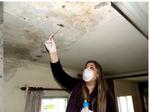
Fig. 35_Toma de muestra c/hisopo estéril en cielorraso de sala de reuniones (M8) Fuente: imagen propia de la autora
