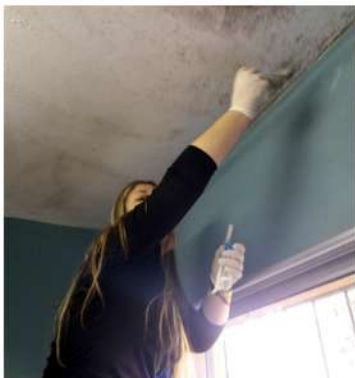
Fig. 32_Toma de muestra con hisopo estéril en cocina (M4) Fuente: imagen propia de la autora
