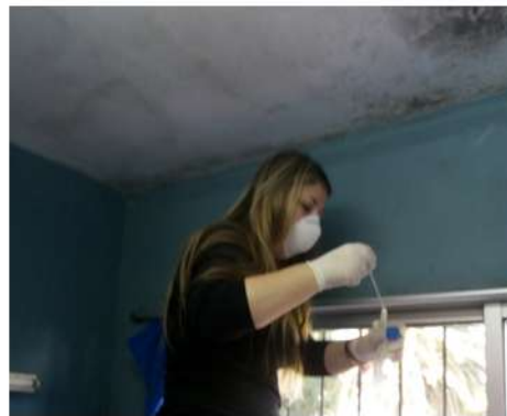
Fig. 33_Guardado de hisopo con muestra en tubo plástico (M4) Fuente: imagen propia la autora
