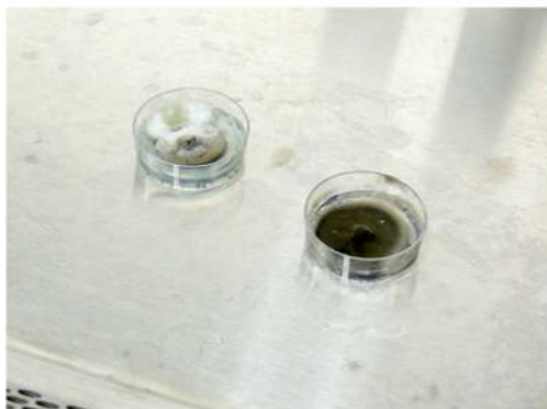
Fig. 31_Placas de PDA con el cultivo de las muestras extraídas del apartamento Fuente: fotografía tomada por la autora
