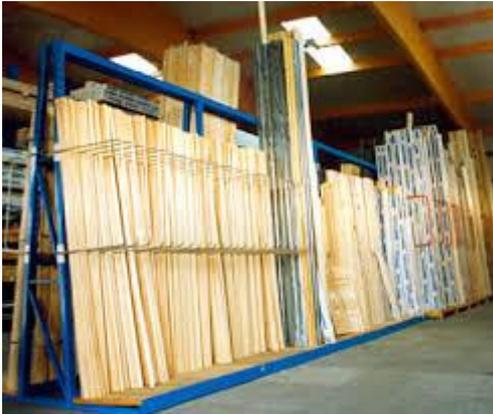
Figura N°74: Estanterías verticales para acopio de madera
