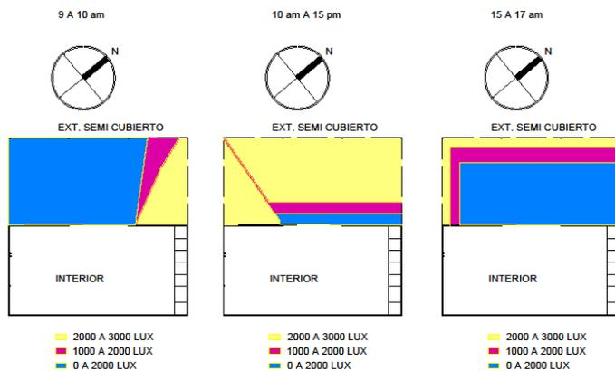
Figura N° 11: Esquema demostrativo con respecto a la orientación.
