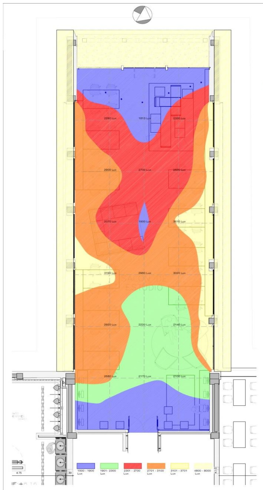
Figura 48. Modelo distribución de la iluminación Natural Sala de Estudio A.
