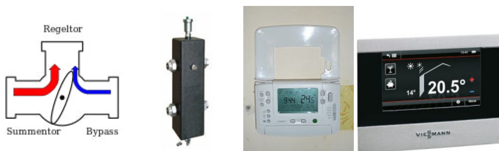
Figura 79. Válvula de 3 vías, aguja hidráulica, termostato zonal y sonda exterior.
