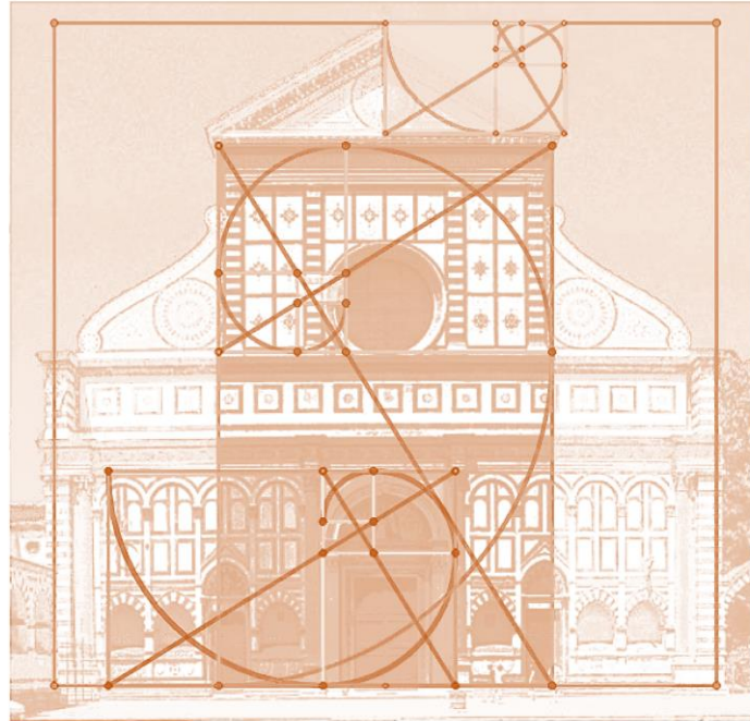
Fig. 14: Comprobación de la sección áurea en el diseño de la fachada de Santo María Novela. Fuente: Elaboración propia utilizando GeoGebra
