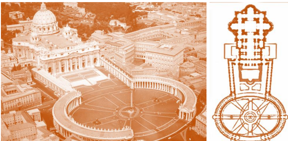
Fig. 50 / 51: Foto aérea de la plaza y trazado geométrico del óvalo de la Columnata. Fuente: Trazado geométrico propio
