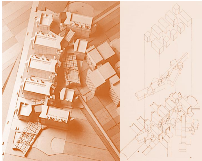
Fig. 119: Universidad de Frankfurt, República Federal Alemana. Maqueta de conjunto - axonómica eclosionada: unidades básicas, columna vertebral, conjunto de volúmenes.
