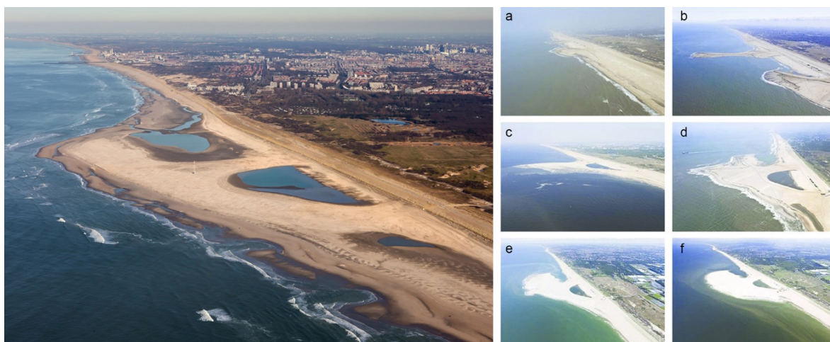
Fig. 10. The Sand Engine, provincia de Zuid Holland. El diseño de la duna expandida en forma de península va modelándose mediante la acción de mareas y vientos, para progresivamente extenderse a lo largo de la costa como buffer de protección ante tormentas y alza del nivel del mar. En la secuencia de fotografías aéreas se observa el proceso de construcción durante: a) 15 de Marzo, 2011; b) 25 de Marzo, 2011; c) 25 de Abril, 2011; d) 17 de Mayo, 2011; e) 14 de Junio, 2011; f) 11 de Julio, 2011. Fuente: https://www.dezandmotor.nl/
