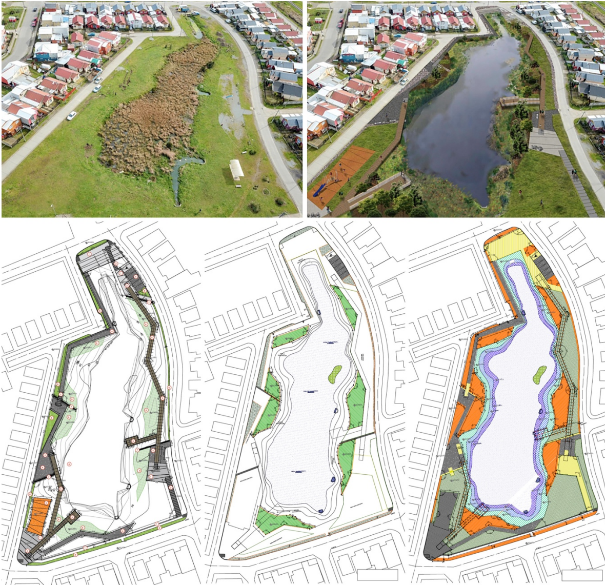
Fig. 22. Parque Humedal Baquedano, proyecto detonante del Plan de Infraestructura Verde Urbana para Llanquihue, Región de Los Lagos, Chile. Arriba: fotomontaje con imagen objetivo (derecha), contrastando con situación previa (izquierda). Abajo: secuencia de planos con las operaciones de diseño, que se concentran en los bordes del Humedal, configurando un sistema de Franjas, Nodos y Áreas destinado a generar un ámbito de mediación ecológica y social. Considera la recuperación de las funciones del humedal en tanto infraestructura hidráulica para prevenir inundaciones en periodos de lluvias intensas, mediante: 1) la restauración de los ecosistemas riparios; 2) la ampliación de la lámina de agua, y; 3) el ordenamiento de las dinámicas de retención, conducción e infiltración de precipitaciones y run-off a través de jardines y canales de infiltración adyacentes a la vialidad. Además, contempla la habilitación de circulaciones y áreas programáticas que contribuyen a comprender el humedal como espacio de encuentro comunitario, especialmente focalizado en los niños y niñas del barrio Baquedano. Fuente: Elaboración propia en base a fotografía aérea y planos de proyecto.
