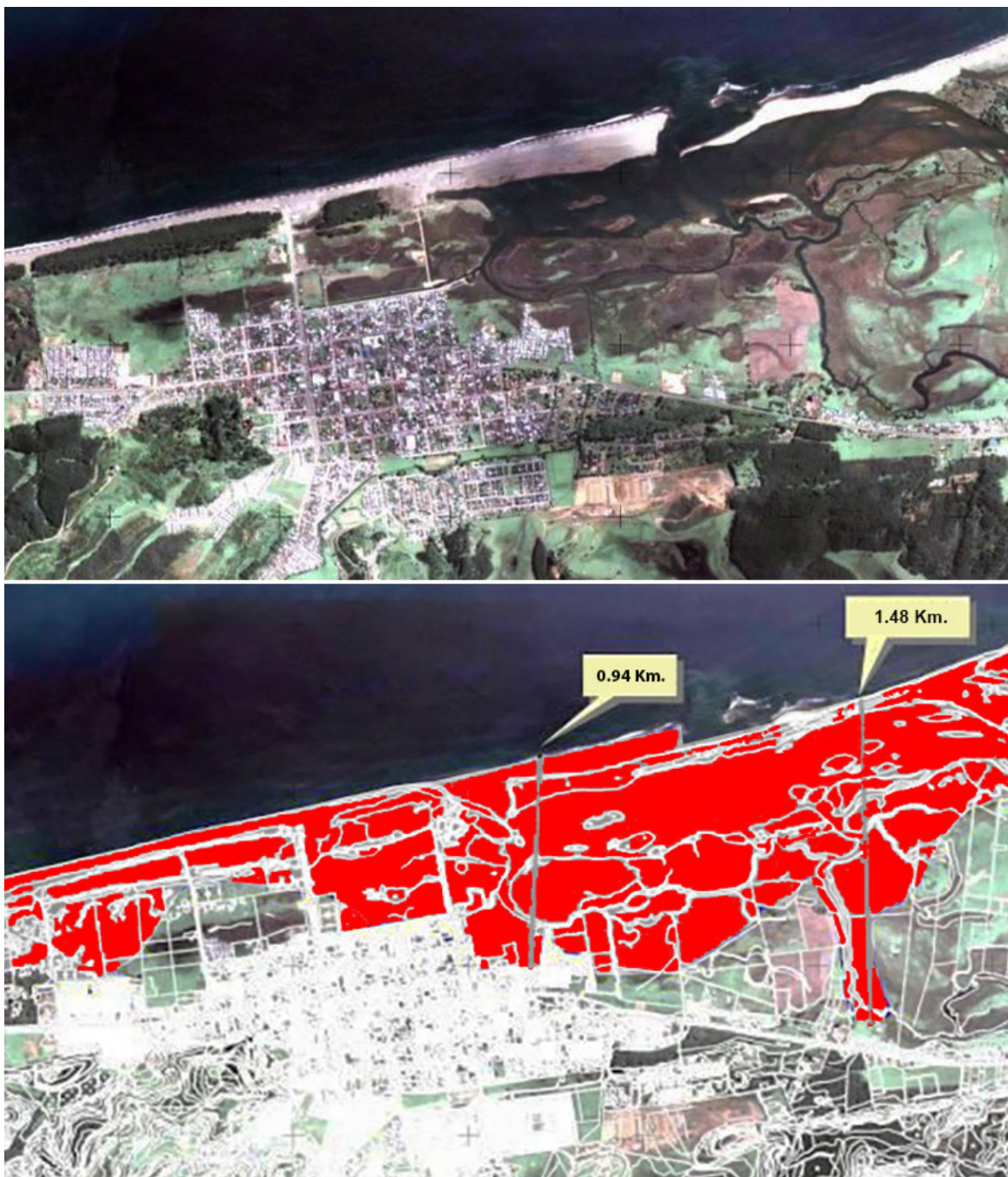
Fig. 37 Carta de inundación modelada en la localidad de Arauco, región de Biobío. Se observa el rol de los humedales costeros y el cordón dunario como infraestructura de amortiguación de los efectos de inundación en el Tsunami del 27F. Arriba, Imagen satelital de la localidad de Arauco. Abajo, Plano con área de inundación del tsunami del 27F en la localidad de Arauco. Fuente: Belmonte et al. (2011).
