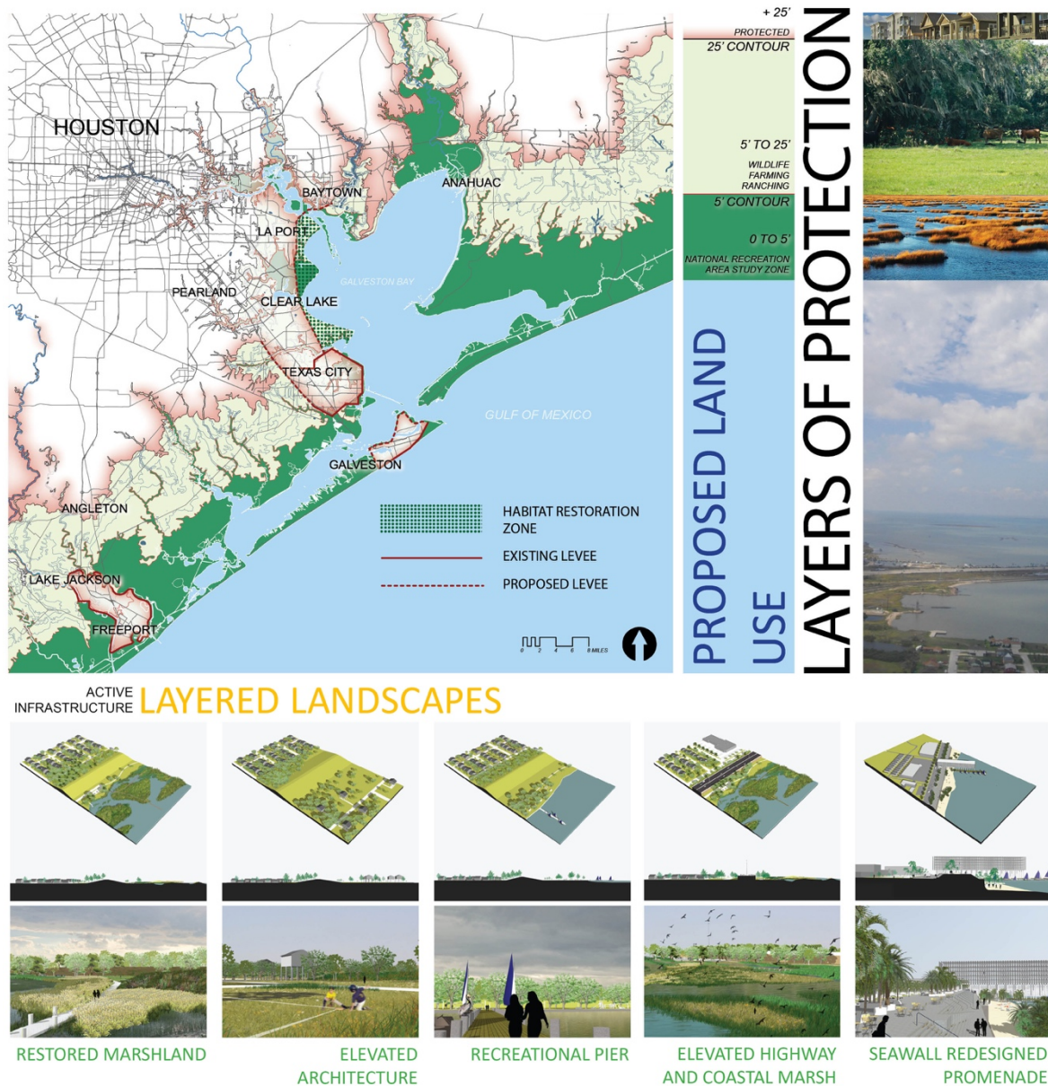
Fig. 108. Houston Coastal Planning for Galveston Bay. Arriba se grafica el alcance territorial del plan, que integra un amplio conjunto de áreas silvestres de ecosistemas ribereños para conformar una primera capa de protección, que se complementa con una segunda franja asociada a zonas productivas agrícolas, estableciendo un buffer de protección mediante infraestructura verde. Un tercer componente, de carácter estructural, lo constituye la franja de la autopista, la cual junto a su rol de infraestructura vial se transforma en una barrera de disipación ante inundaciones provocadas por huracanes. Estas medidas se complementan con instrumentos de planificación de usos de suelo que condicionan la ocupación de zonas de riesgo, a la vez que estimulan la conservación de ecosistemas costeros. Fuente: SWA Group y ASLA, 2012.
