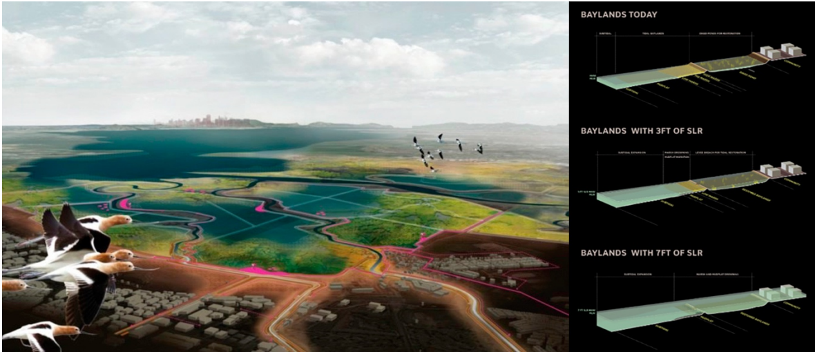
Fig. 8. Public Sediment, de SCAPE, desarrollado bajo el alero de la iniciativa Resilient by Design: Bay Area Challenge. Mediante el manejo ecológico de los sedimentos aportados por los diversos cursos fluviales que desembocan en la Bahía de San Francisco, el proyecto propone amplificar el ecotono del borde costero, generando gradientes ecológicas para la conservación de hábitat y biodiversidad, el desarrollo de actividades productivas y recreativas. Esta ampliación de borde contribuye como infraestructura para la resiliencia de las áreas urbanas ante el alza del nivel del mar, marejadas y tsunamis. Fuente: http://www.resilientbayarea.org/
