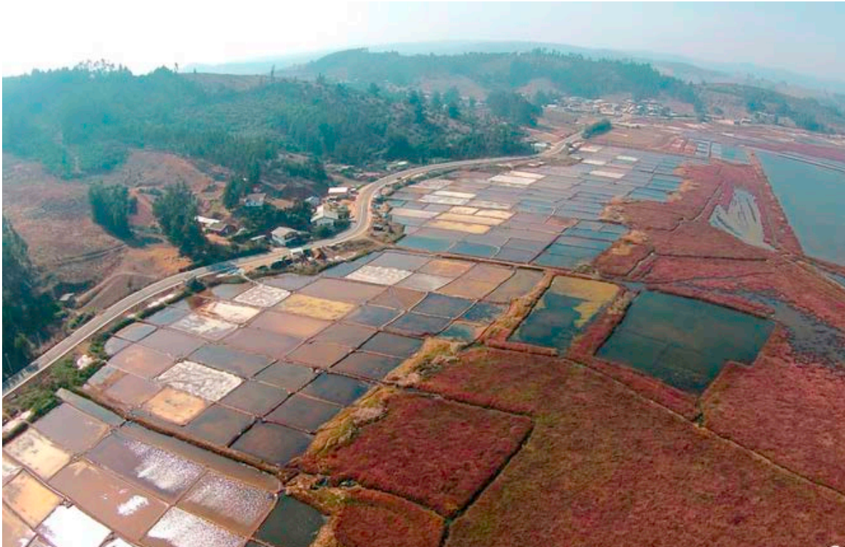
Fig. 23. Salinas de Boyeruca – Lo Valdivia, en el límite norte de la región del Maule. El paisaje productivo se basa en las dinámicas de intercambio mareal del estuario, que favorece la mezcla progresiva entre aguas dulces y saladas. Para manejar este intercambio, las infraestructuras productivas generan un borde que va filtrando las aguas, produciendo en su laminación una secuencia temporal que involucra la acción de la radiación solar y el viento, luego de la cual los componentes salinos afloran a la superficie para su cosecha. Desde un enfoque ecológico, este proceso contribuye a regular los excedentes hídricos del sistema y la sobreabundancia de materia orgánica o eutrofización, asegurando un caudal propicio para el mantenimiento del ecosistema del estuario. A su vez, este borde infraestructural conforma un buffer de amortiguación para reducir la sedimentación generada por las escorrentías de los cerros colindantes, los cuales desprovistos de su vegetación nativa por plantaciones forestales, actualmente evidencian fenómenos de erosión en sus laderas. Fuente: Fotografía obtenida de vuelo dron. © Romero, Camila (2017).
