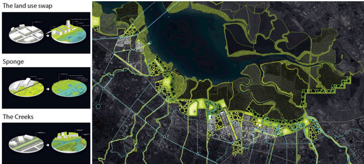
Fig. 9. South Bay Sponge, presentado por Field Operations en Resilient by Design: Bay Area Challenge. La propuesta contempla la recuperación ecológica del borde del estuario conformando grandes sistemas de humedales para la absorción – a modo de esponja – de las variaciones de mareas, tsunamis y otros eventos hidrometeorológicos.. Fuente: http://www.resilientbayarea.org/
