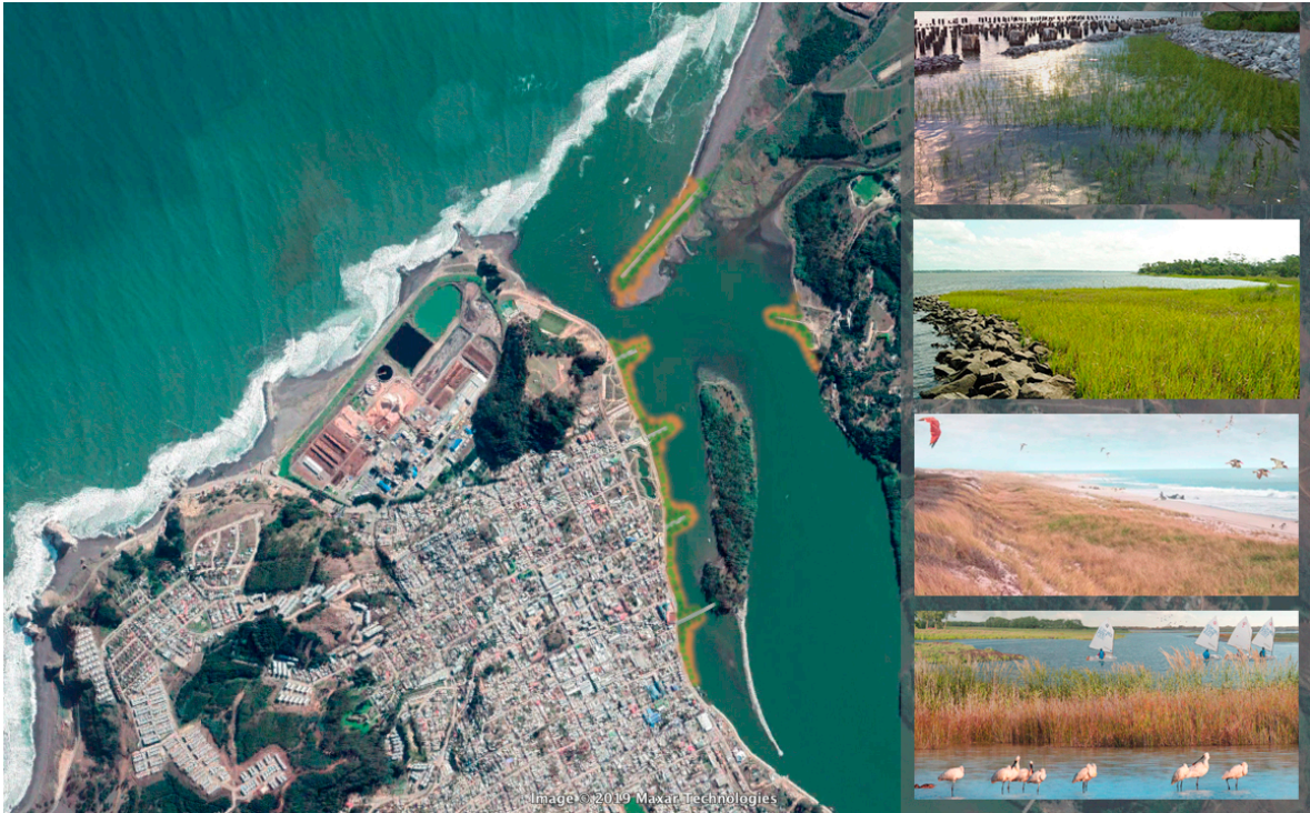
Fig. 109. Imagen Objetivo de las estrategias off-shore aplicadas al caso del Parque de Mitigación de Constitución, a través de espigones perpendiculares a la ribera para promover captura de sedimentación proveniente del río, generando bancos de amortiguación a través de la acumulación progresiva de suelo para establecimiento de vegetación riparia. Las estructuras de captura, sostenidas mediante taludes de enrocado, conforman también dispositivos de rehabilitación de ecosistemas de ribera y de soporte para el desarrollo de actividades recreativas y productivas. Fuente: Elaboración propia en base a imágenes Google Earth ©.
