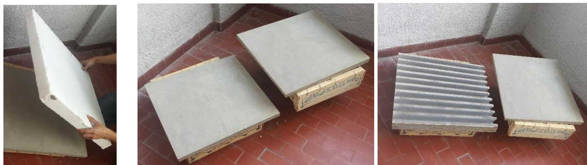
Figura 74. Desencofrado y resultado final de las placas de concreto. Fuente: Elaboración propia.
