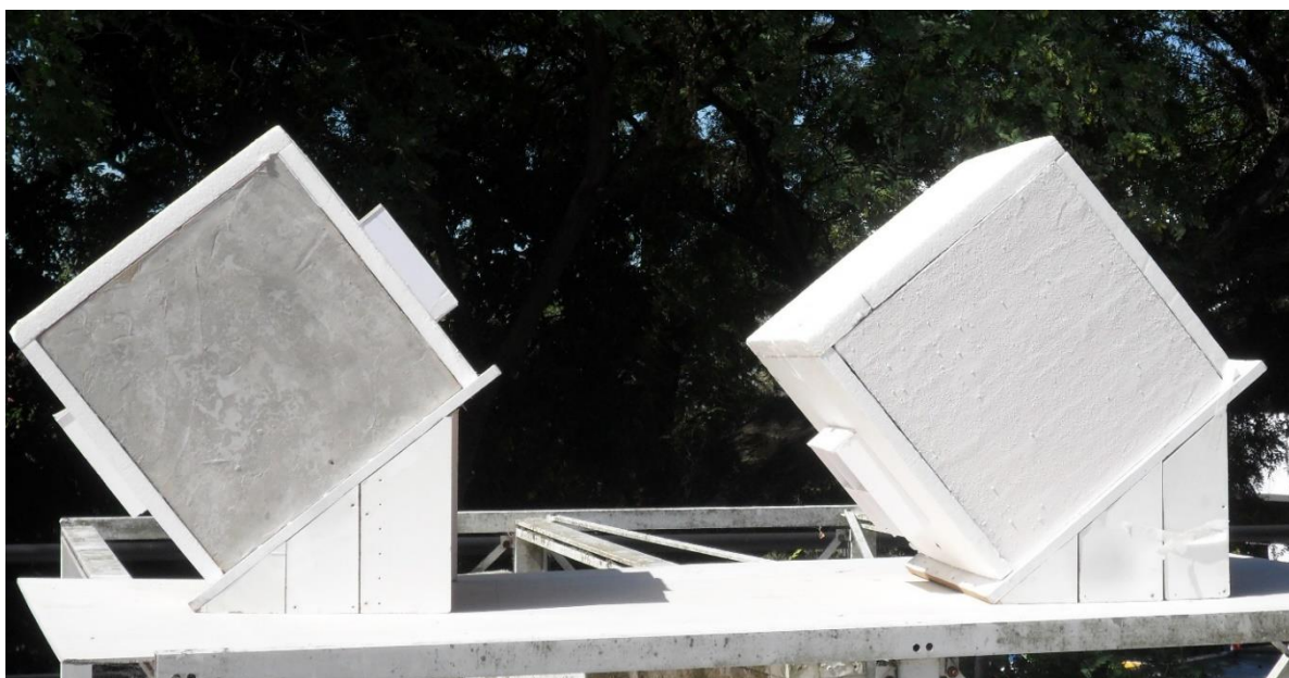
Figura 94. Configuración del aparato experimental para experimentación con la estrategia de revoque refractario. Fuente: Elaboración propia.
