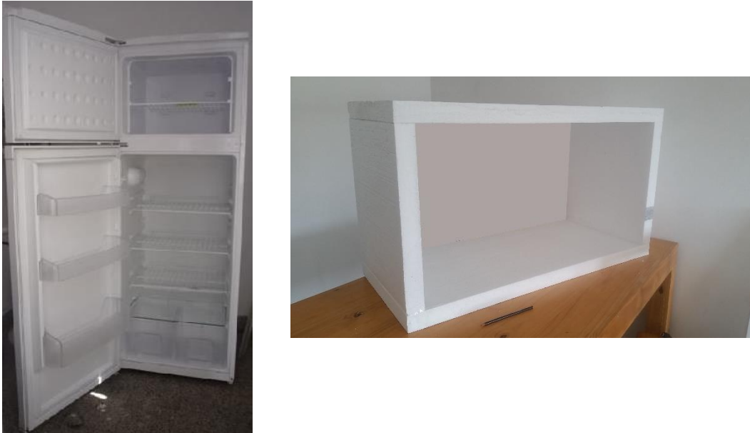
Figura 119. Lado izquierdo: unidad enfriadora (Heladera sigma modelo S3100), lado derecho cámara caliente. Fuente: Elaboración propia.
