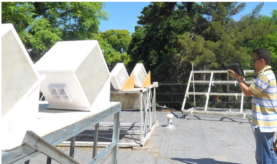
Figura 78. Captura de termografías. Fuente: Elaboración propia.
