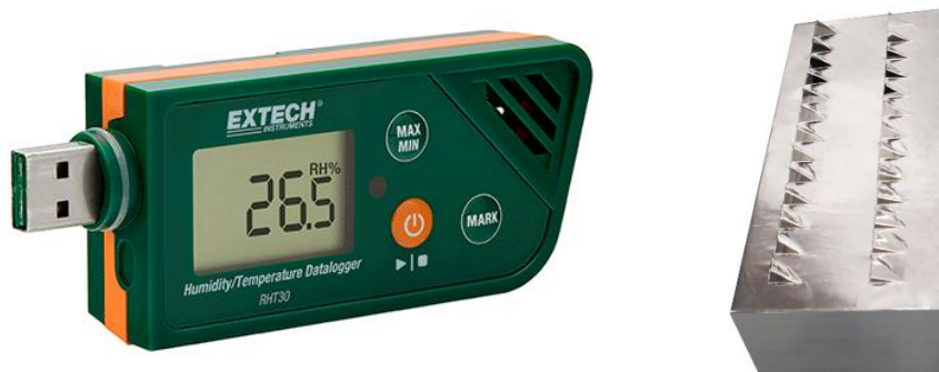
Figura 160. Datalogger Extech, modelo RHT30 y cajilla de protección contra radiación. Fuente: Elaboración propia.
