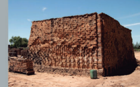
Paso 7°-enfriado del ladrillo:
