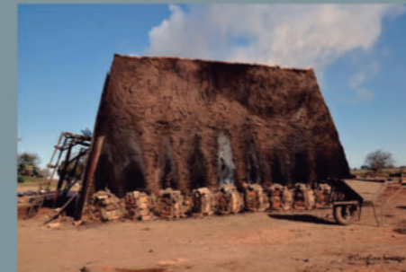
Paso 6°-horneado del ladrillo:
