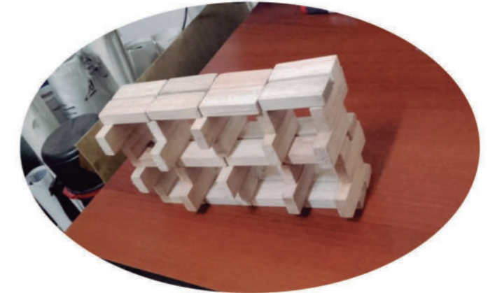
Aparejo: criba ortogonal dentado 25x25 ( CO25)
