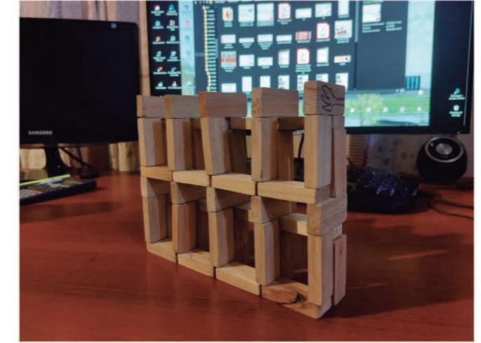
Aparejo: criba ortogonal trabado 25x25 ( COB13)
