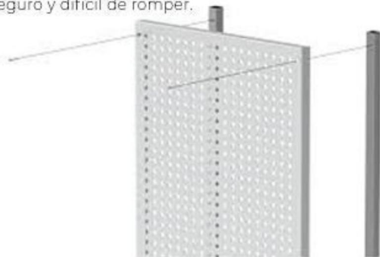
La chapa microperforada utilizada como "piel metálica" como solución industrial posee una muy buena visibilidad desde el interior, y otorga privacidad desde el exterior; además, actúa como moderador solar, ya que ayuda a disminuir los puntos de reflexión de la luz.
