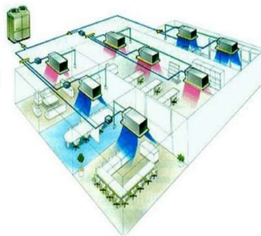
g) Sistema V.R.V. con recuperación de calor
