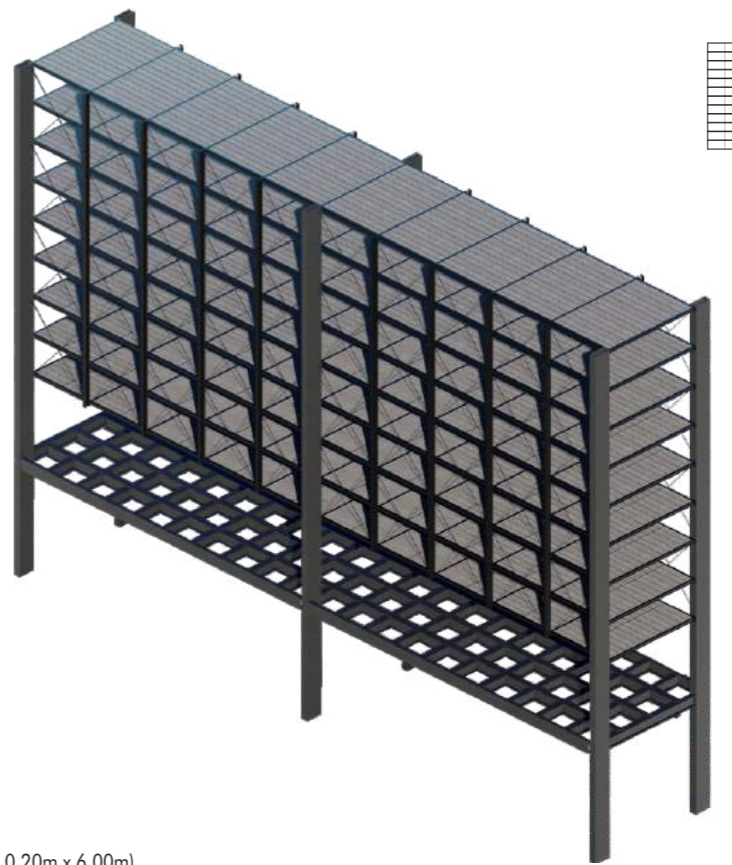
DOBLE "T" O "I" INTERCALADAS PARA APOYO DE LOSETAS
