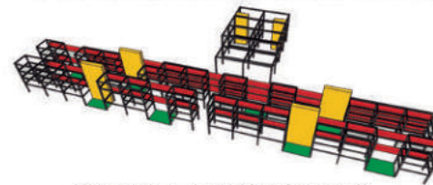
PRIMERA ETAPA - ARMADO DE ESTRUCTURA PREFABRICADA HºAº
