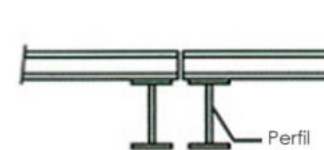
APOYO SOBRE PERFIL METÁLICO
