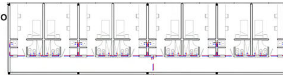
DETALLE DE SANITARIO VIVIENDAS PROVISIÓN AF/AC
