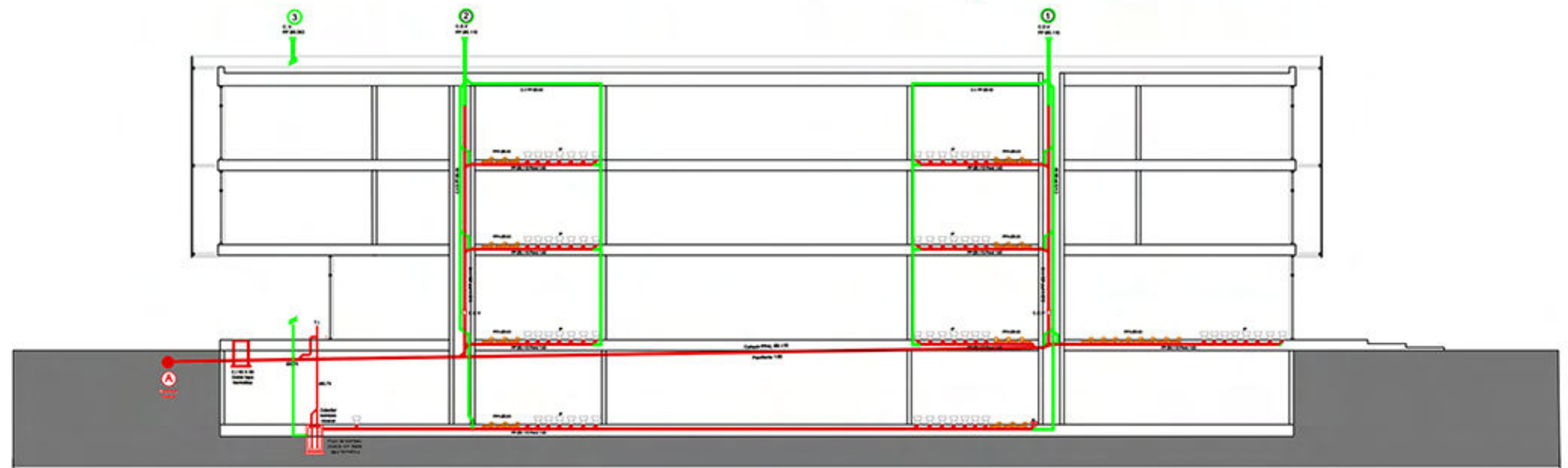
DETALLE DE NÚCLEO SANITARIO PROVISIÓN AF/AC
