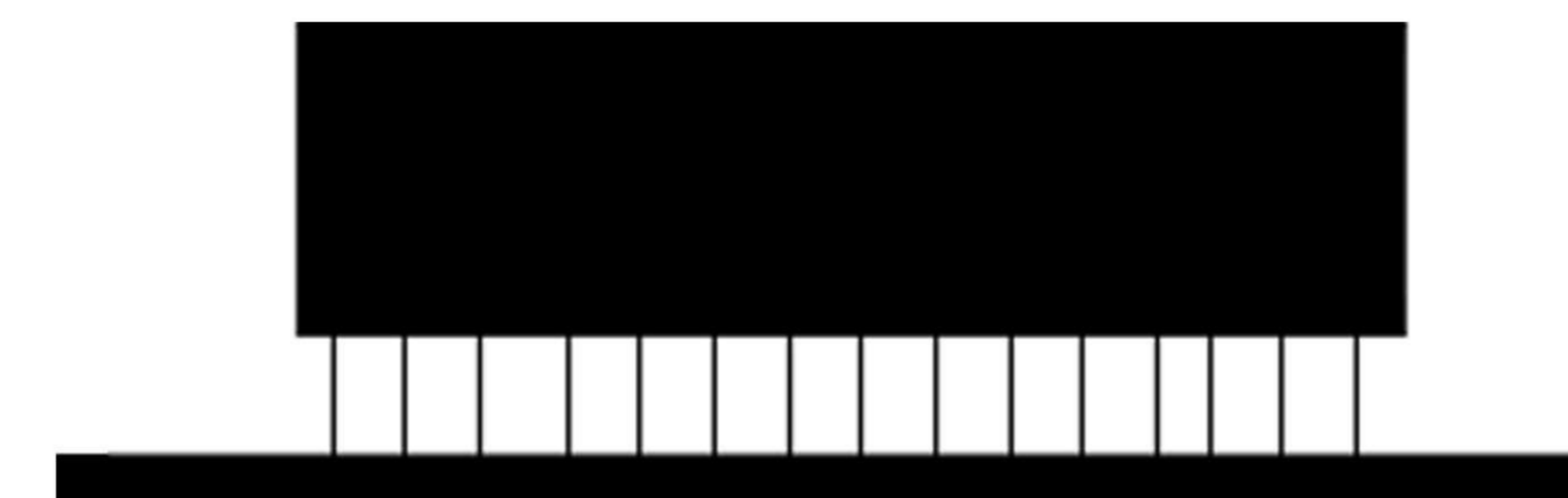
Palafito / Separación del suelo
