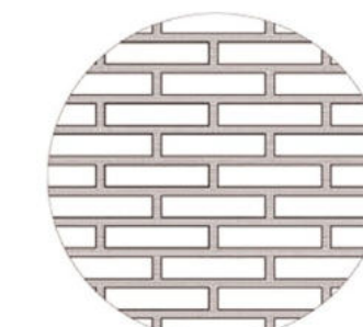
LADRILLO VISTO. APAREJO A SOGA
