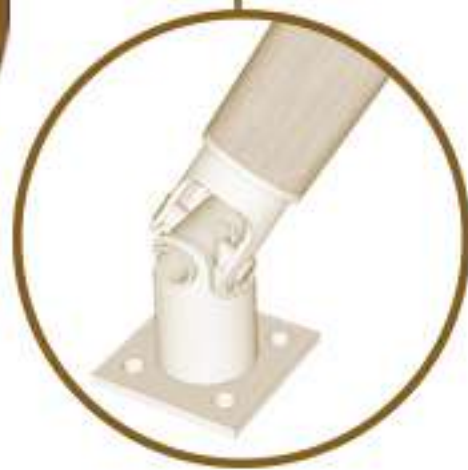
ANCLAJE DE TENSORES METÁLICOS
