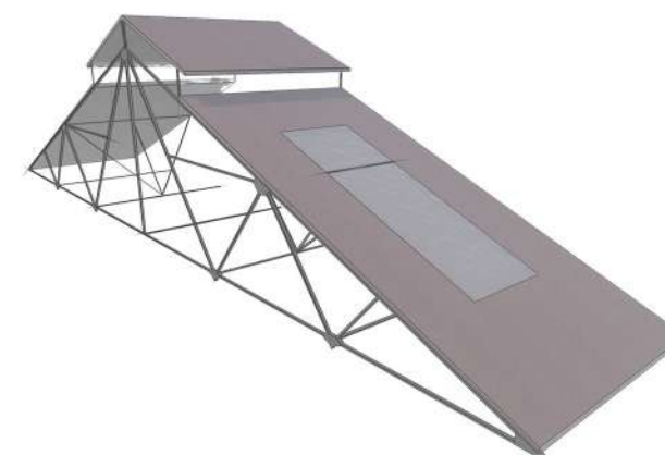
Cubierta con cabriadas metálicas y chapa ondulada
