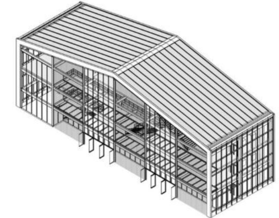
5. Envolvente resuelta con paneles prefabricados de varios tipos según su requerimiento, apoyado sobre un entramado metálico.
