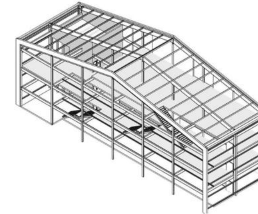
4. Entramado metálico de vigas de entepiso se apoyan en columnas intermedias y en los pórticos.
