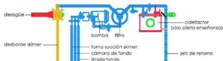
Acondicionamiento piscina: DETALLE
