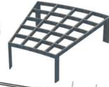
Estructura de Transición, Emparrillado de Vigas
