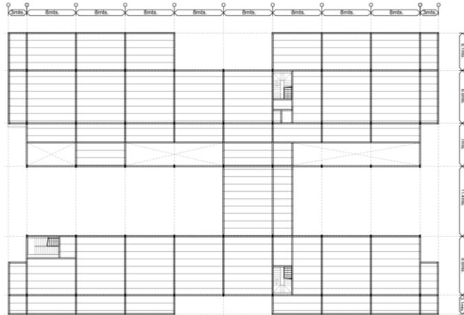
El sistema de losas pretensadas supone una ventaja constructiva debido a la velocidad de montaje y a la flexibilidad que presentan, con varias medidas y espesores.
