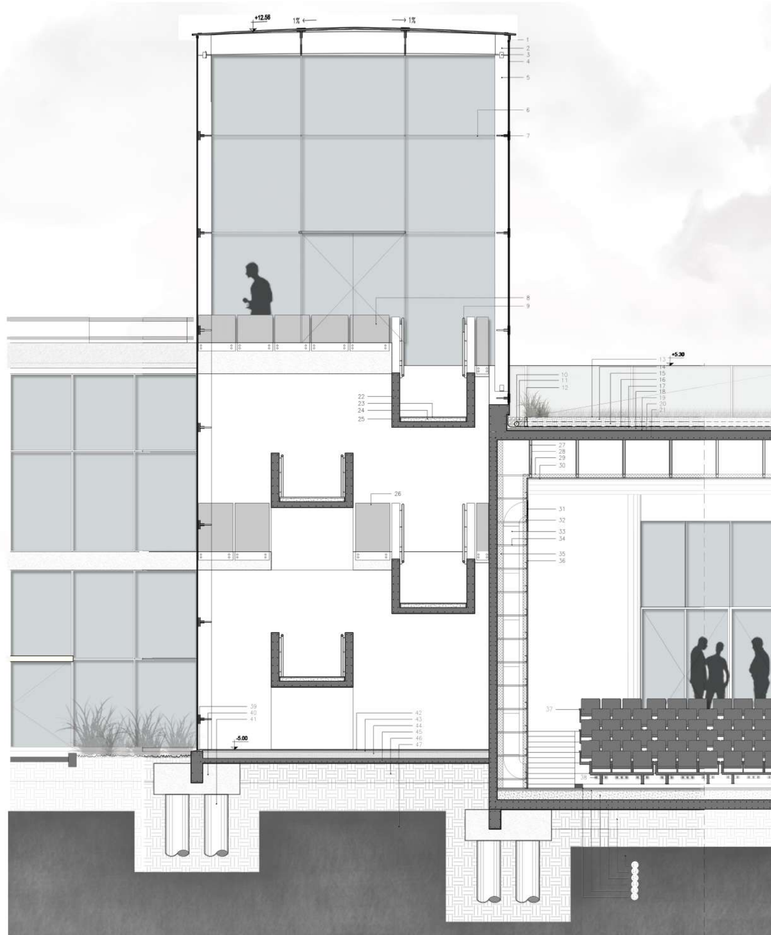
1. Conector de vidrios en acero inoxidable triple 2. Viga Soporte vidrio templado 8mm 3. Conector de vidrios en acero inoxidable 90° 4. Vidrio DVH 5. Soporte lica 10. Caño cribado 11. Grava 12. Cordón de Hormigón prefabricado 13. Sistema de riego por goteo 14. Suelo fértil 15. Caño cribado 16. Geo textil 17. Flex Pla 24. Carpeta/contra piso 25. Junta de dilatación 26. Baranda de vidrio 27. Montante cielorraso auditorio 28. Solera cielorraso auditorio 29. Absorbente acústico 31. acondicionado 34. Solera sostén, estructura paneles 35. Aislación acústica 36. Placa Madera Micro perforada 37. Butaca Rassegna curva 38. Difusor Inyector de terreno compactado 46. Tosca compactada 47. Terreno natural
