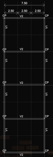
CERRAMIENTO HORIZONTAL DEL MÓDULO BASE
