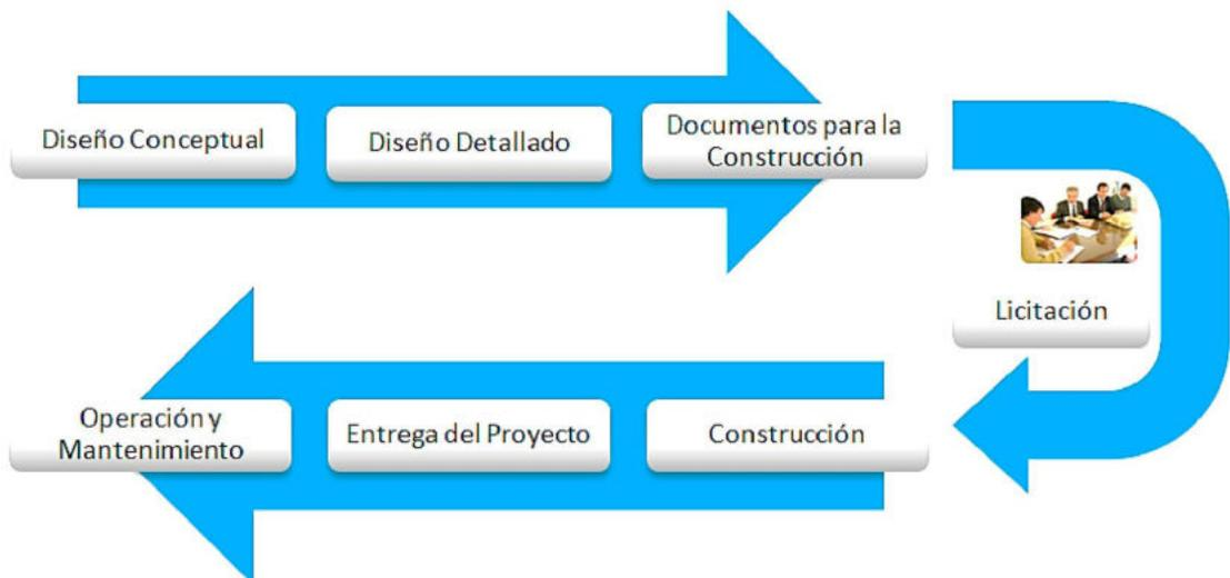
**Figura N° 1.** Flujo del sistema tradicional para la entrega de proyectos de construcción, basado en el modelo Diseño/Licitación/Construcción.
