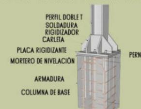
PARA LOS VOLUMENES PROGRAMÁTICOS (INVESTIGACIÓN · SALAS Y AULAS) SE UTILIZARÁ ESTRUCTURA DE ACERO PARA COLUMNAS Y VIGAS. DIMENSIONADAS S/CÁLCULO:
