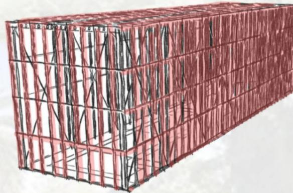
RIGIDIZACIÓN MEDIANTE TENSORES (DESPLAZAMIENTO POR VENTOS)
