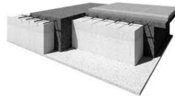
LOSAS CON VIGUETAS Y LADRILLO EPS
