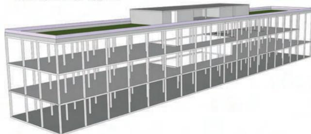
Predimensionado: 15 cm de espesor de losa, Columnas de Hormigón armado de 20x20, luces de 4mts. Pilotes de Hormigón de 40cm de diámetro y aumento de sección a 60cm (bulbo). Armadura superior en faja de columnas 16 c/15 c/15 Armadura inferior 10c/15 c/15.
