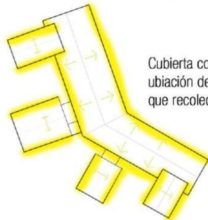
Cubierta con sus pendientes y ubicación de canaletas que recolectan el agua de lluvia
