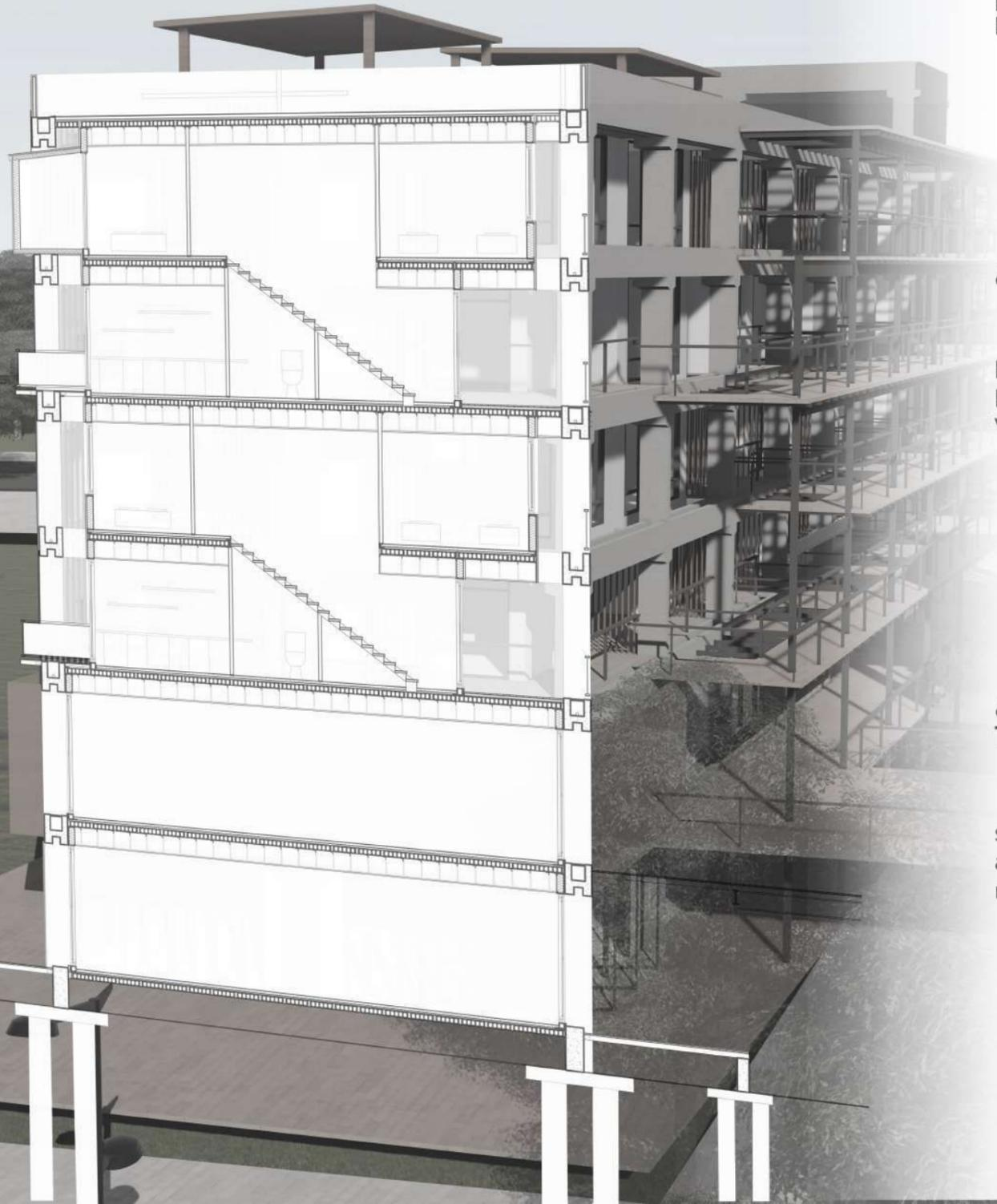
En base a las premisas planteadas se optó por la utilización del sistema de **Steel framing** para el cerramiento del edificio, ya que se trata de materiales conocidos y accesibles para el común de la población, además de otorgar flexibilidad y rapidez en el diseño y montaje, reduciendo también el porcentaje de desperdicios en comparación con la obra húmeda.
