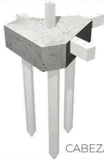
CABEZAL DE 3 PILOTINES
