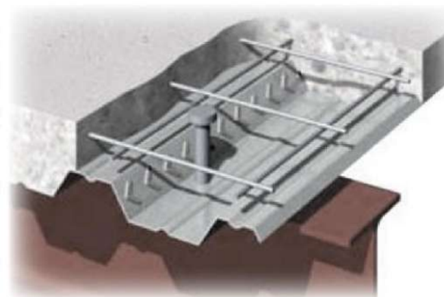
EJEMPLO ENCUENTRO VIGAS DETALLE STEEL DECK
