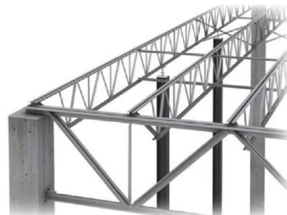
EJEMPLO ENCUENTRO VIGAS DETALLE STEEL DECK
