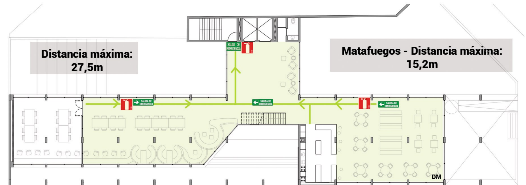
Plano evacuación planta primer piso
