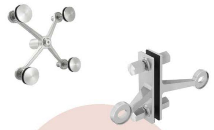
Los paneles de vidrio poseen una subestructura metálica, columnas de sección circular con un diámetro de 15cm, sujeta a la estructura principal de Hormigón Armado. Cada columna posee 3 arañas con 4 agarres cada una y 2 arañas con 2 agarres en los extremos de la misma.
