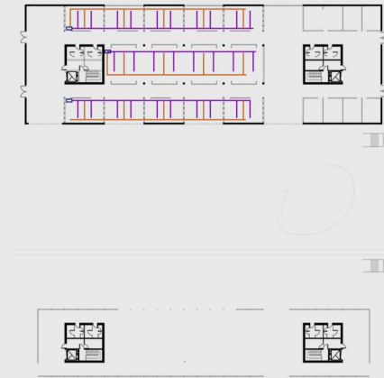
Sistema de acondicionamiento area administrativa
