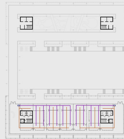
Sistema de acondicionamiento laboratorios
