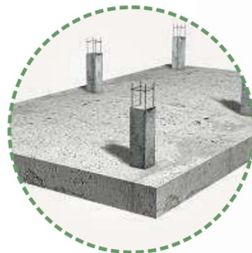
Se utiliza como fundación de los núcleos de circulación vertical, plateas reforzadas de hormigón armado
