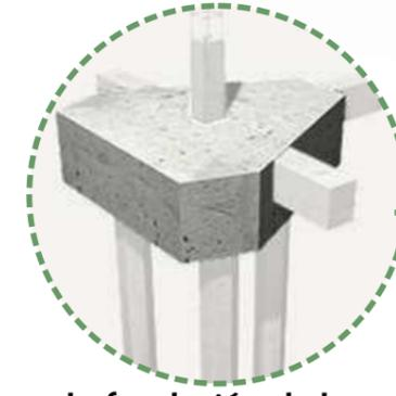
Para la fundación de la estructura puntual se utilizaron cabezales con pilotines hormihonados in situ.
