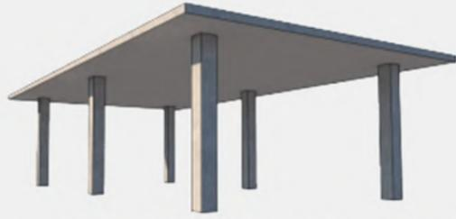
EL SISTEMA DE LOSAS PLANAS GENERA MECANISMOS ESTRUCTURALES MÁS FLEXIBLES YA QUE ESTÁ CONFORMADO POR LOSAS DE BAJO ESPESOR Y Poca RIGIDEZ
