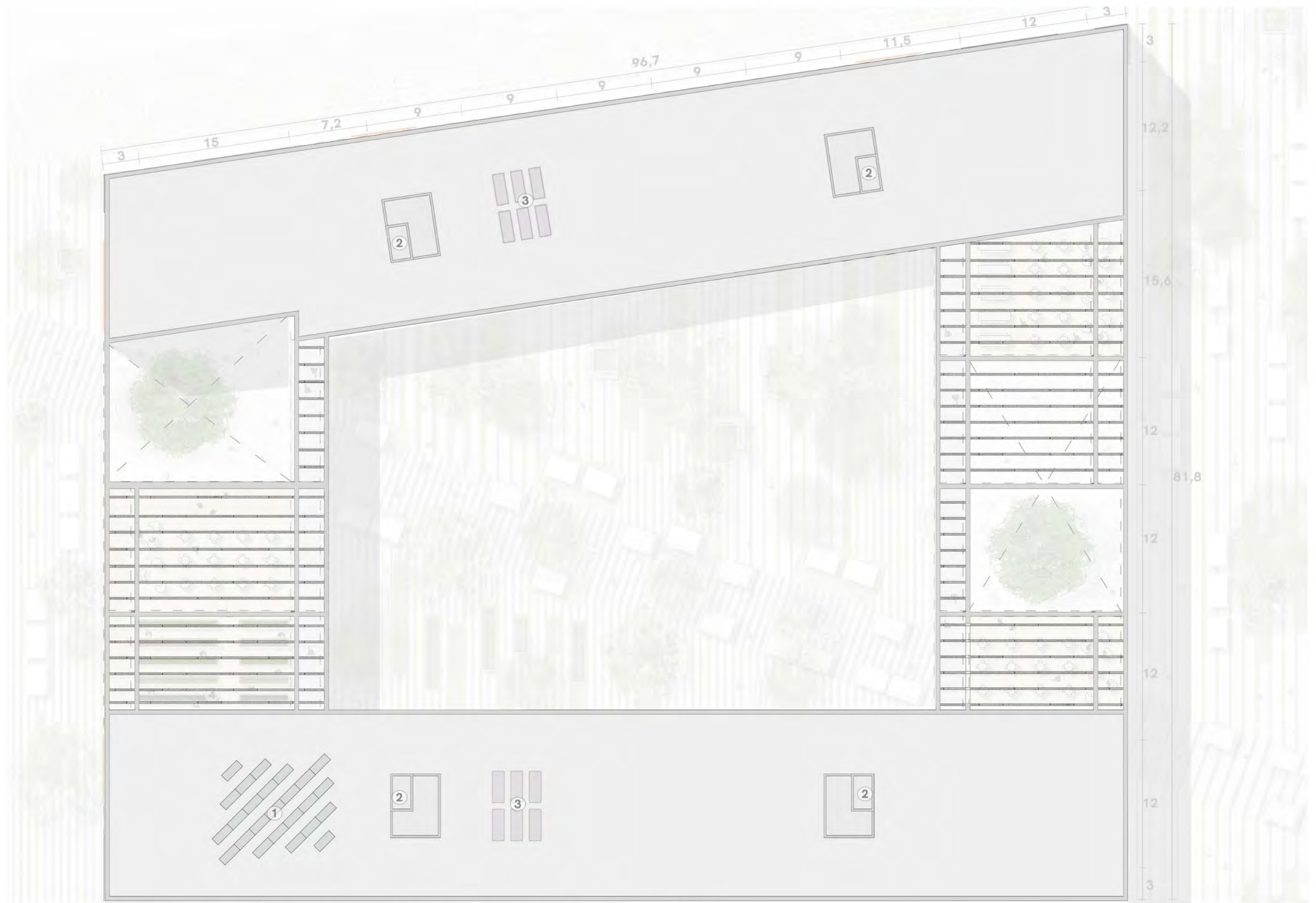
1 Paneles fotovoltaicos alimentación hidroponía - 2 Tanque mixto - 3 Unidades exteriores VRV - 4 Pérgola
