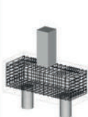
COLOCACIÓN DE ARMADURA EN CABEZAL
