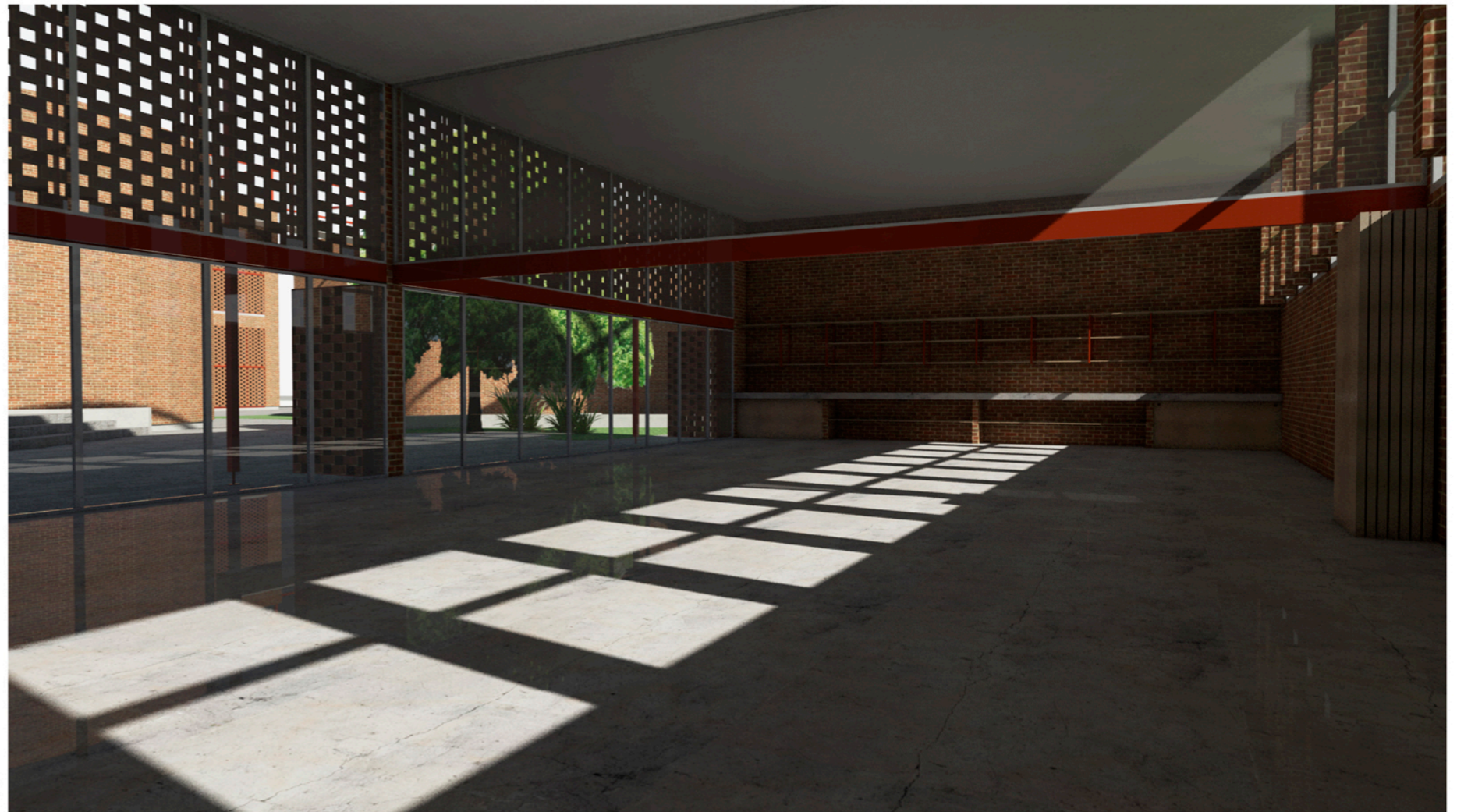
DOBLE PIEL: PANELES OPACOS ABIERTOS / VIDRIADOS CERRADOS RELACIÓN VISUAL DEL AULA CON EL PATIO
