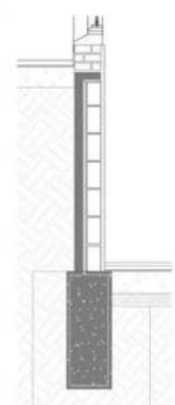
Tabique de submuración
