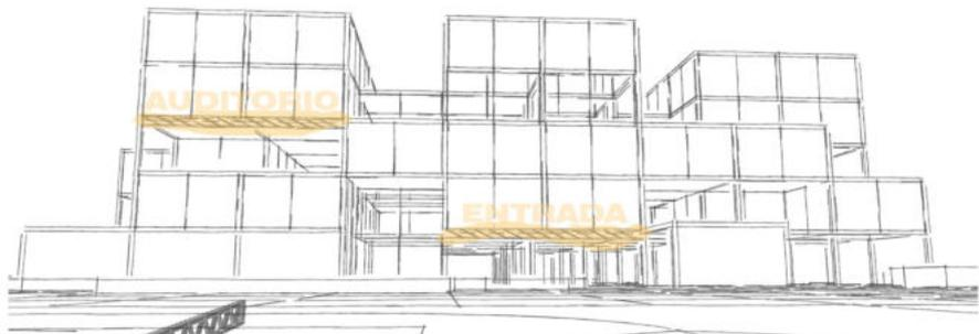
En estas situaciones que hay faltante de columna y queda una luz de 14,40 metros, decido utilizar una viga reticulada de UPN 300 con una altura de 80 centímetros.
