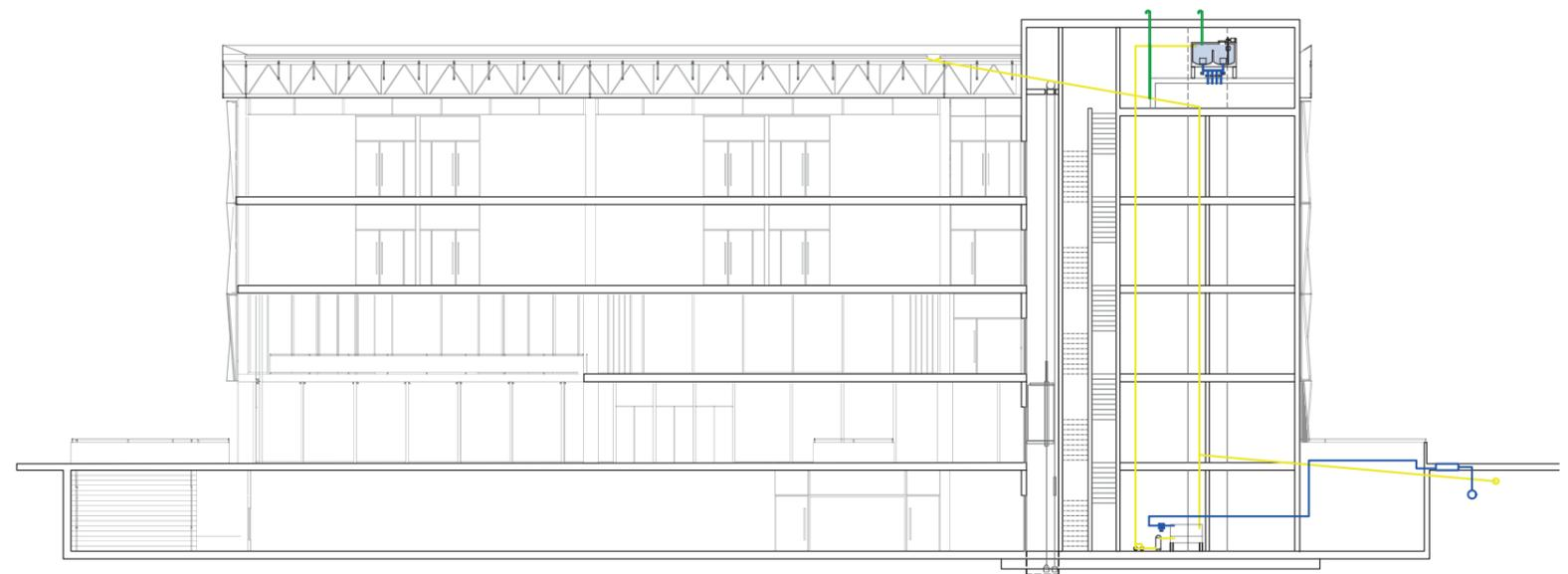
CORTE POR NÚCLEO + SISTEMA DE RECUPERACIÓN DE AGUAS PLUVIALES
