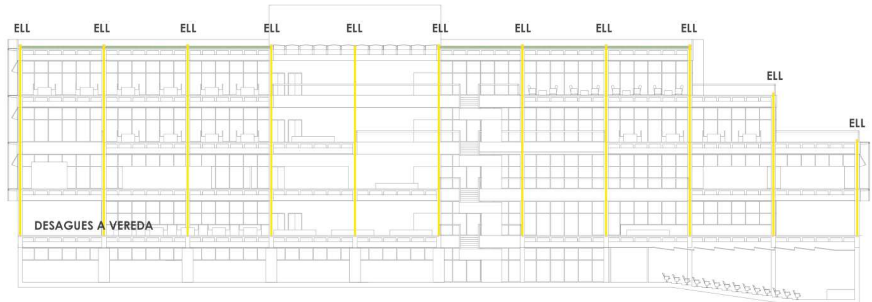
CORTE DESAGUE PLUVIAL
