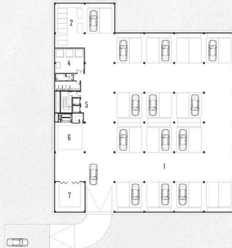
1- ESTACIONAMIENTO VEHICULAR 2- ESTACIONAMIENTO MOTOS / BICICLETAS 3- SANITARIOS 4- DEPOSITO TANQUES 5- NÚCLEO VERTICAL 6- CARGA Y DESCARGA DE MATERIALES PESADOS 7- DEPOSITO GENERALES
