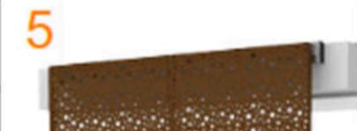
5. Una vez fijada la fila superior de paneles, repetir la secuencia de fijación de los paneles en la fila consecutiva inferior.
