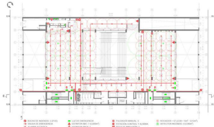
Instalaciones Contra Incendio Planta Ingresos
