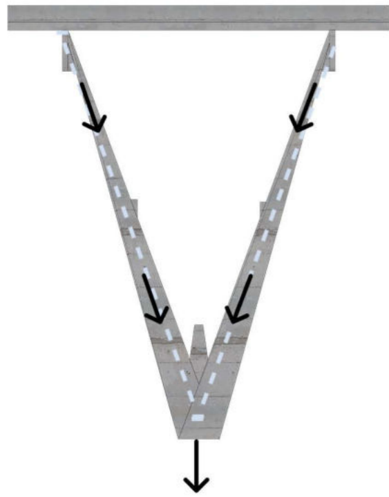
CAMINO DE CARGAS
